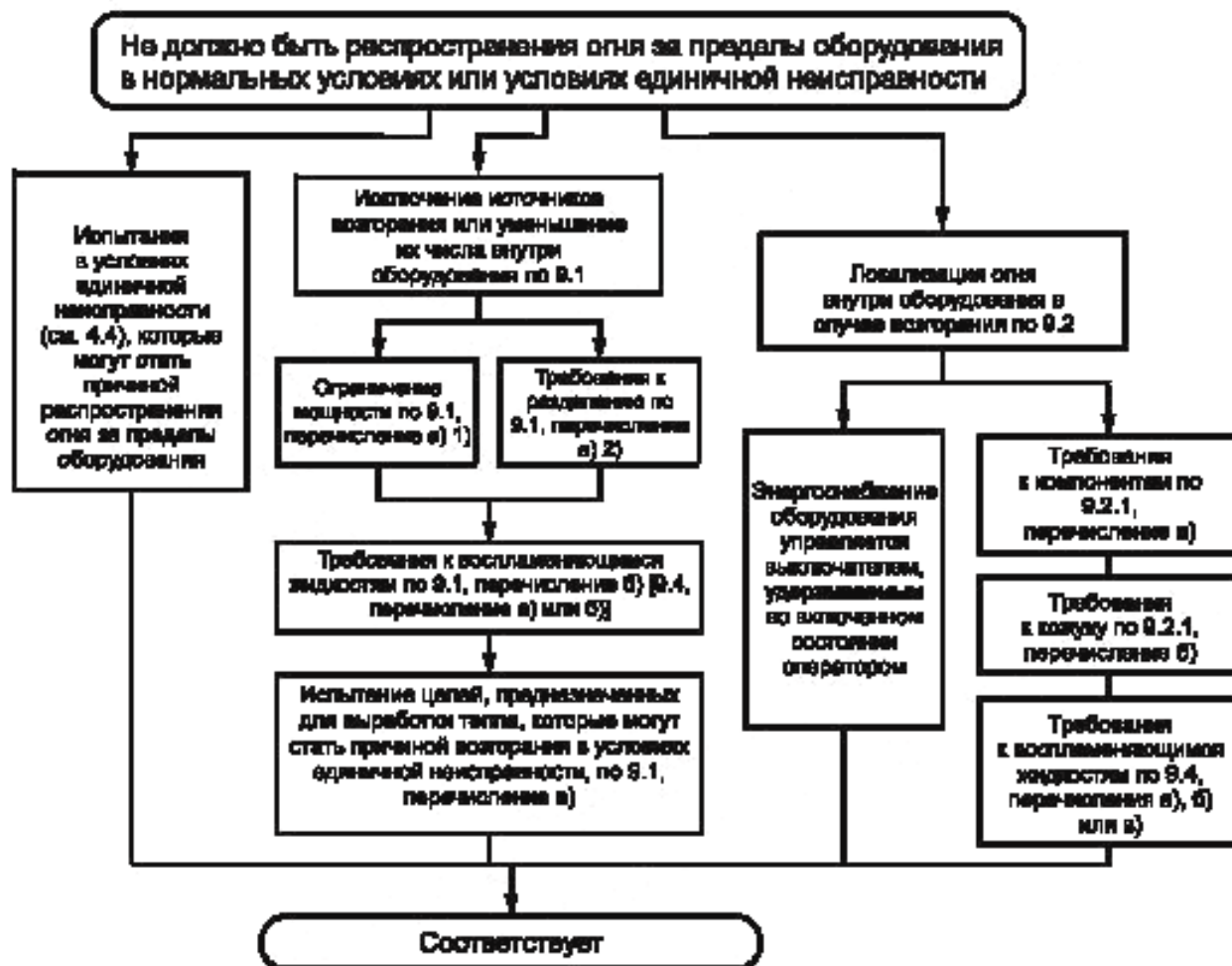
Рисунок 5 — Блок-схема, поясняющая требования к защите от распространения огня
